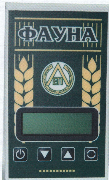
Рисунок 1 – Общий вид влагомеров «ФАУНА-АМ»
